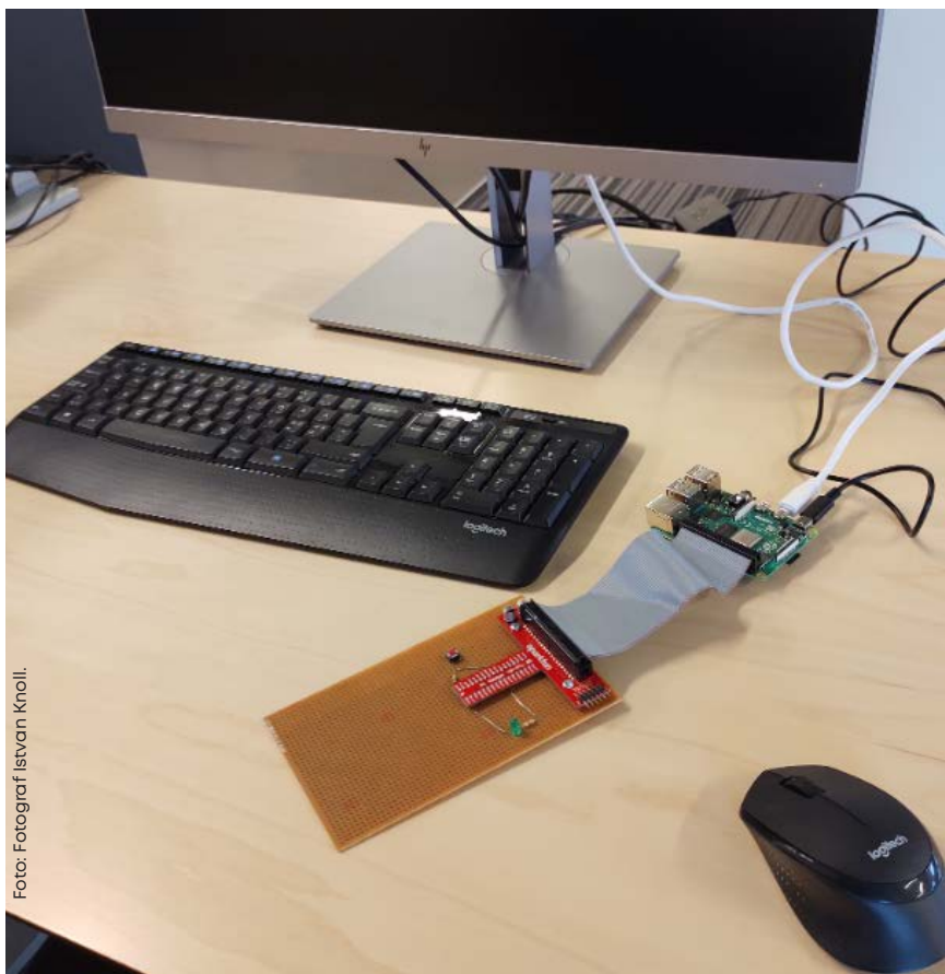
Figur 2: Den samlede hardwareopstilling med perifere enheder.
